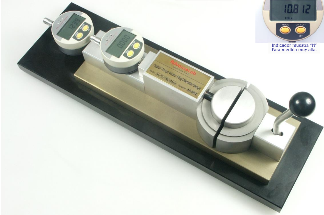
Indicador muestra "Go" Para la medida deseada.
