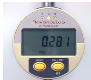
Indicador muestra "Go" Para la medida deseada.
