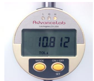
Indicador muestra "H" Para medida muy alta.
