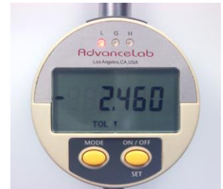
Indicador muestra "L" Para medida muy baja.
